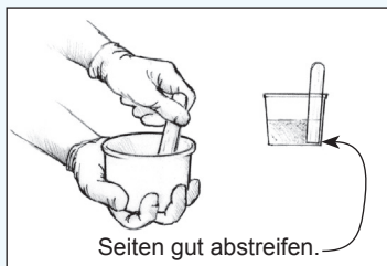
Abbildung 3 Mischen Sie das Harz und den Härter gründlich für zwei Minuten, bei kälteren Temperaturen länger.
