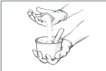
Abbildung 4 Mischen Sie geringe Mengen des entsprechenden Füllstoffs bei, bis Sie die gewünschte Konsistenz erzielt haben.
